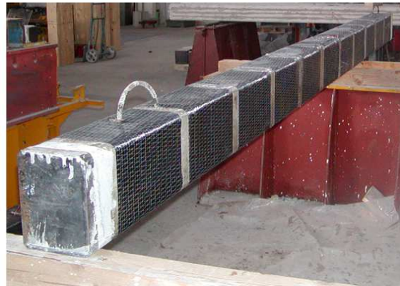
b) CFRP sheet wrapping
