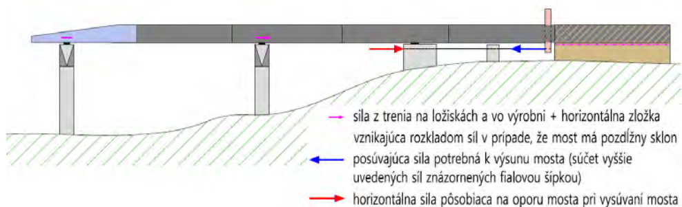
Obr. 40: Horizontálna sila pôsobiaca na oporu počas vysúvania mosta
