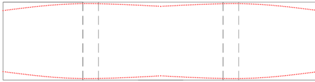
Obr. 63 Schéma deformácie hornej dosky segmentu vplyvom nerovnomerného zmrašťovania (pohľad zhora).
