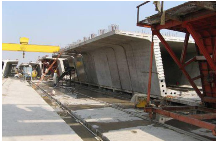
Obr. 54 Výroba segmentov na dlhej dráhe (ScS).
