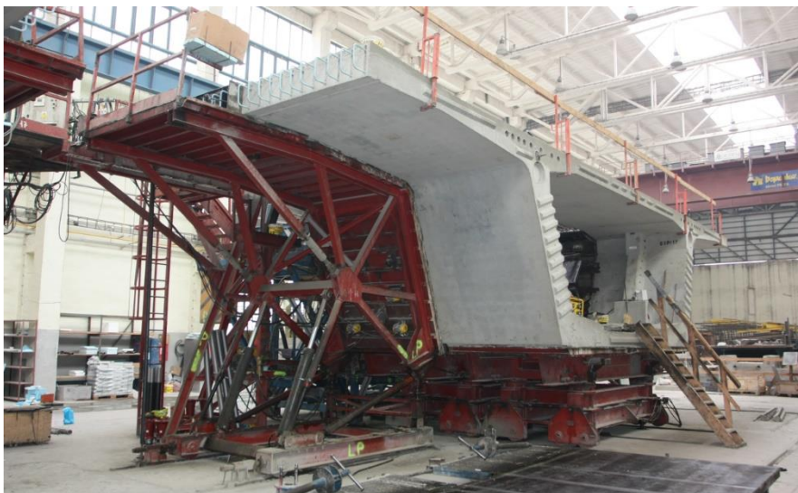
Obr. 56 Výroba segmentov na krátkej dráhe (prefa firmy Doprastav a.s., Senec, 2017).
