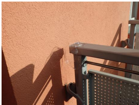
Obr. 9 Mýdlové bubliny na plastové zátce na straně „I“
