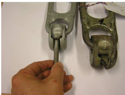
Obr. 5 Porovnání rozměrů zdvihacího oka pro hmotnostní kategorii 1,3 t (vlevo) a na stavbě použitého zdvihacího oka (vpravo) a transportní kotvy 1,3t.
