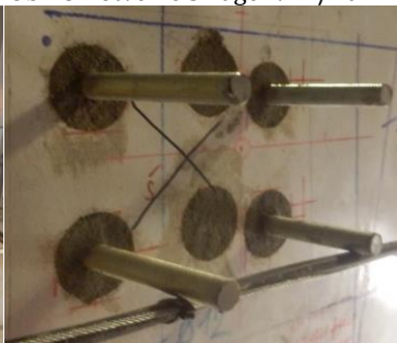
Obr. 8 Kotvenie s Pagel V14/10
