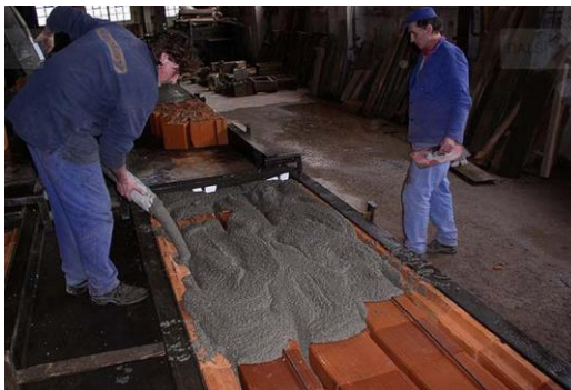
Obr. 2 Výroba keramických panelov
