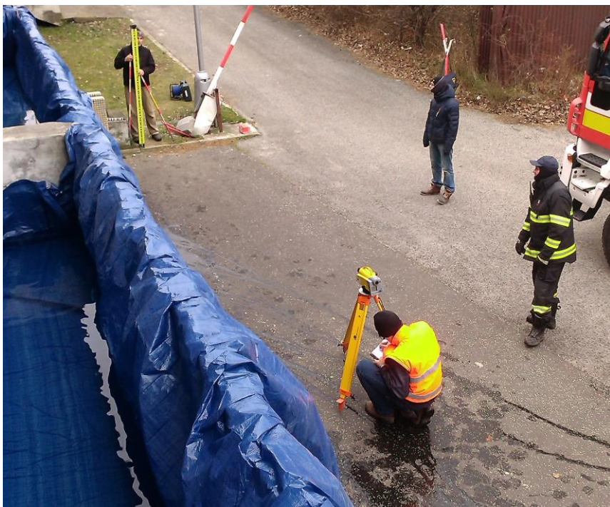
Obr. 8 Zaťažovacia skúška – zaťažovanie vodou a geodetické meranie priehybov
