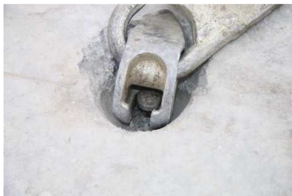
Obr. 4 Zkušební nasazení zdvihacího oka (2,5 t) na transportní kotvu. Viditelná vůle transportní kotvy v závěsném oku.
